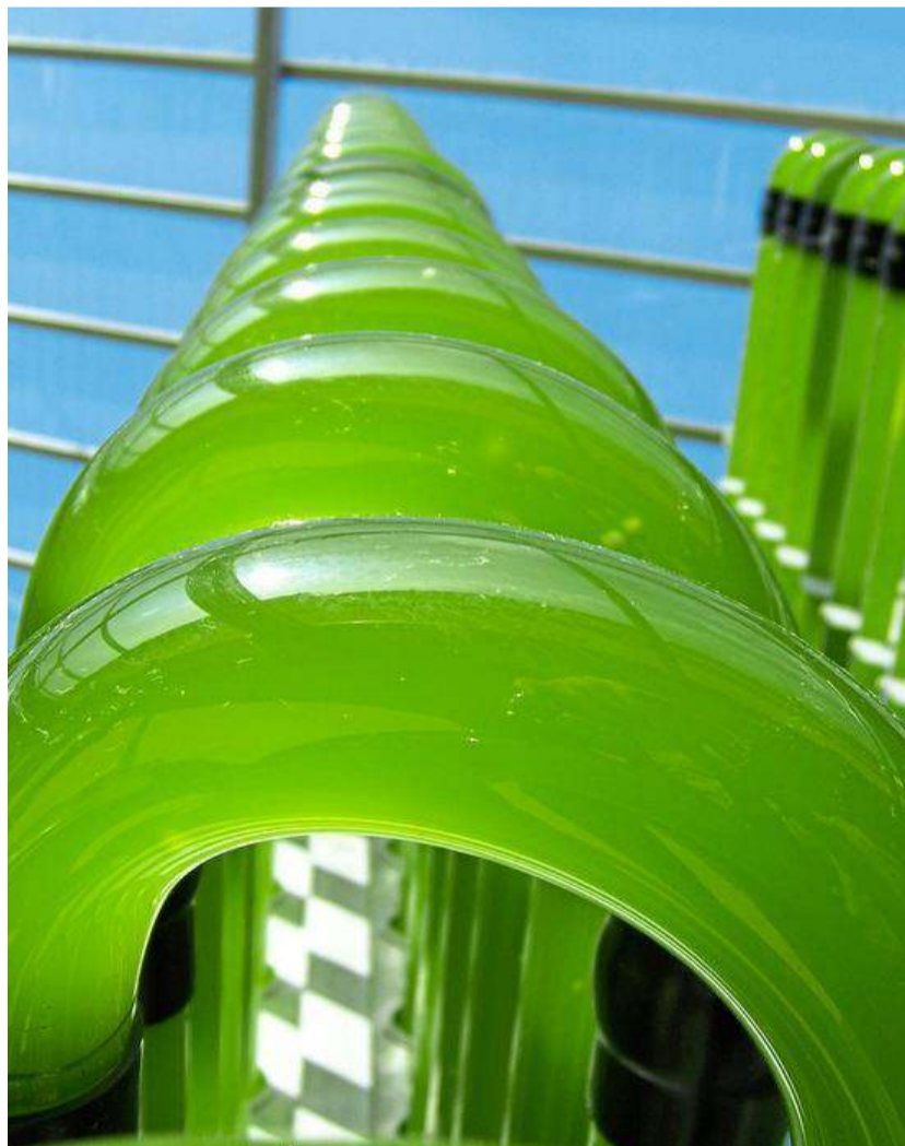
Fotobioreaktoren: Algen wachsen in großen Glasröhren.
